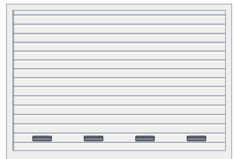
Мотив 480, филенка в виде секций с вентиляционной решеткой Поперечное сечение вентиляционных прорезей 40 см 2 на решетку
