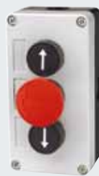
Клавишный выключатель Тройной «Откр.-Авар. выкл.-Закр.» Пластмассовый корпус, IP 65
