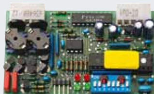
Анализатор индукционной петли Вставляемая плата, 1- или 2-канальная, пригодна для двух отдельных индукционных петель, поставляется без петлевого кабеля
