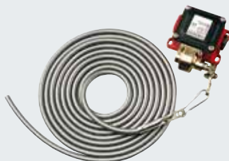
Выключатель с тяговым шнурком, с тяговым тросом из пластмассы Возможен монтаж в вертикальном или горизонтальном положении, отлитый под давлением алюминиевый корпус, IP 65, длина троса 4 м
