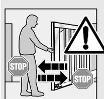
Poučte všechny osoby, které používají vratový systém, o správné a bezpečné obsluze. Předvedte a otestujte mechanické odemykání a bezpečnostní zpětný chod. K tomu bránu zastavte oběma rukama během zavírání. Vratový systém musí zahájit zpětný pohyb.
